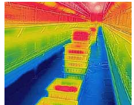
Imagem termográfica. Atente que o chão está sempre frio
